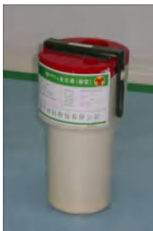
左 ^{99}\text{Mo} - ^{99m}\text{Tc} 发生器实物图 右 ^{99}\text{Mo} - ^{99m}\text{Tc} 发生器内部结构图 1. (吸附 ^{99}\text{Mo} 的) 色谱柱 2. 双针插座 (插盐水瓶) 3. 单针插座 (插真空瓶) 4. 铅屏蔽体 5. 铅防护容器
